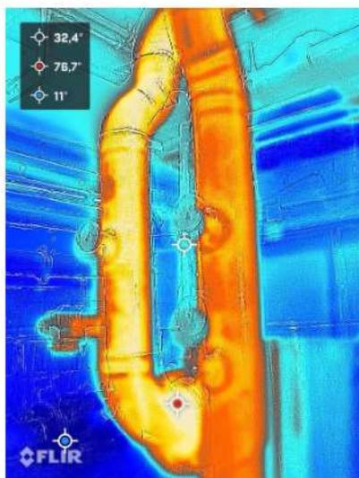
Bei der Begehung wurde festgestellt, dass Rohrleitungen im Heizungsraum (unbeheizt) z.T. nicht gedämmt sind. Dies führt zu enormen Energieverlusten, gerade in Kombination mit hohen Vor- und Rücklauftemperaturen (siehe Aufnahme der Wärmebildkamera). Gemäß dem Gebäudeenergiegesetz (GEG) ist es Pflicht, Rohrleitungen in unbeheizten Räumen entsprechend mit Dämmung zu versehen.
